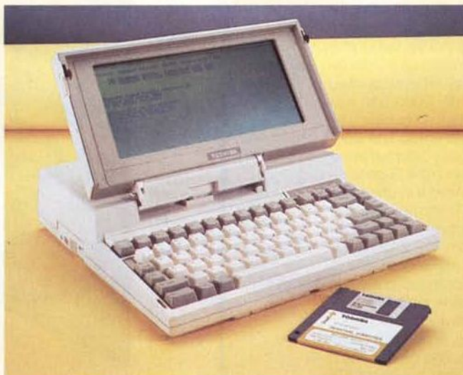
Il Toshiba T1200 segnò un significativo passo avanti nel "mobile computing". A parte l'hard disk da 20 megabyte finalmente integrato nella macchina, il nuovo portatile Toshiba offriva la possibilità, impagabile, di porre il sistema in stato di stop, ovvero di spegnerlo... senza spegnerlo. O, meglio, di riaccenderlo pressoché immediatamente grazie alla memoria salvatati autoalimentata.
